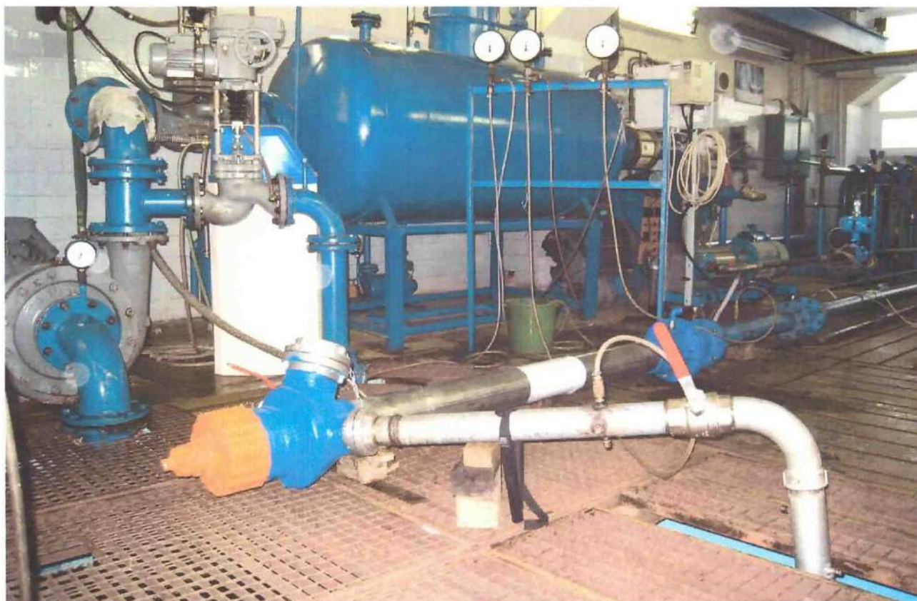
Skúšanie prietokových charakteristík výtokov 2x65 / Testing of hydraulic characteristics of outlets 2x65
